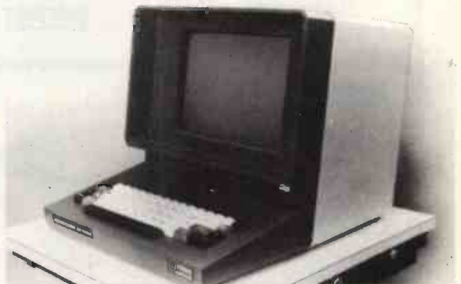
PERKIN ELMER 550 BANTAM. Teletype compatible Visual Display unit.
